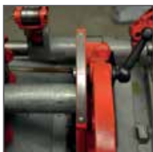
Регулировка глубины нарезки резьбы.
