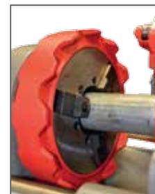
Блокирующий механизм с 2 точками зажима. Легко заменить.
