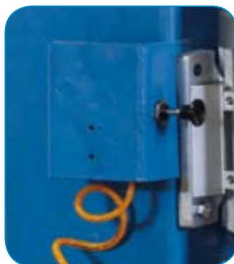
Пульт управления пневматическими стопорами
