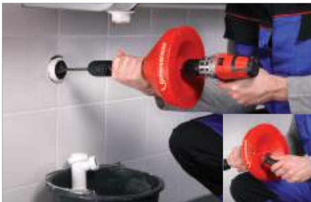
Привод от аккумуляторной дрели
