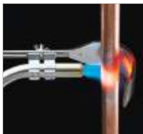
Использование с рефлектором пламени
