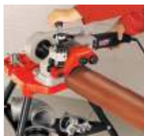
Применение устройства для накатки желобков ROGROOVER
