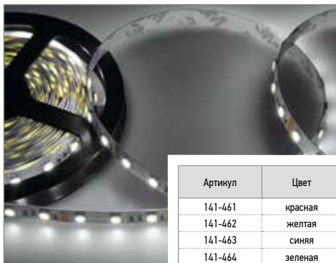
Лента 12 В 60 LED/м, SMD5050, 10 мм шаг резки 5 см
