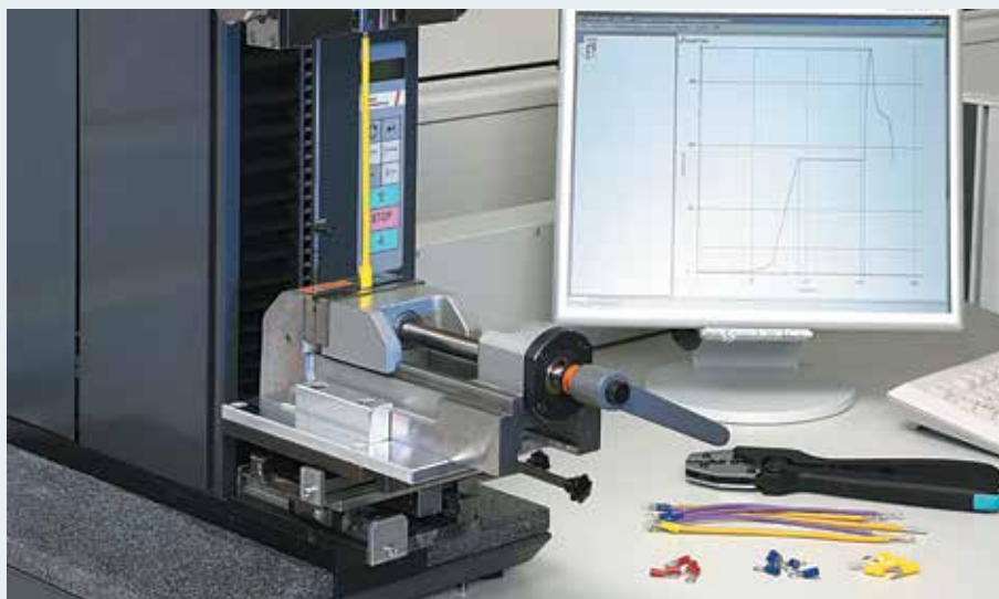
Испытания проводника на выдергивание
