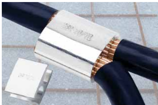
Н-образные соединительные зажимы испытаны токами грозовых разрядов по станд. EN 50164,1 Класс Н (100 кА 10,350 мкс).
