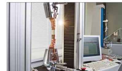
Испытания наконечников на разрывное усилие
