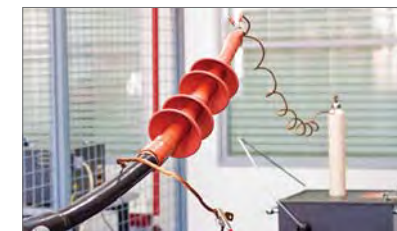
Высоковольтные испытания кабельных муфт
