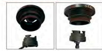
Для удержания шкива закрепите инструмент на коленвале. Закрепив на валу, немного провернуть в сторону для фиксации шкива.
